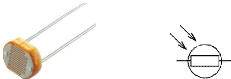
Рис.2. Общий вид и условное обозначение фоторезистора
