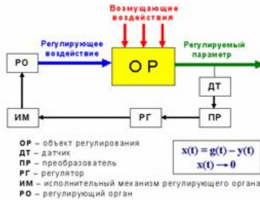
Рис. 3 Структурна схема регулювання по відхиленню
