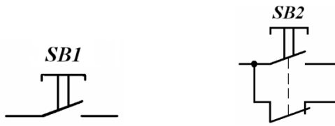
Рис. 11. Примеры условного обозначения кнопок управления
