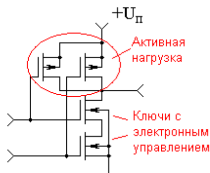
Рисунок 2. Принципова схема логічного елемента "2І-НІ", виконаного на КМОП транзисторах
